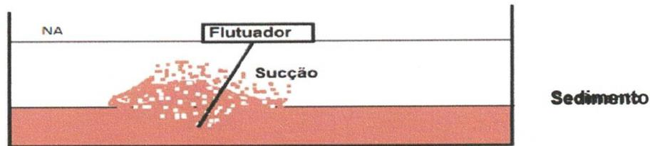
Figura 01 - Lodo sedimentado a ser removido com balsa equipada com draga e bomba
