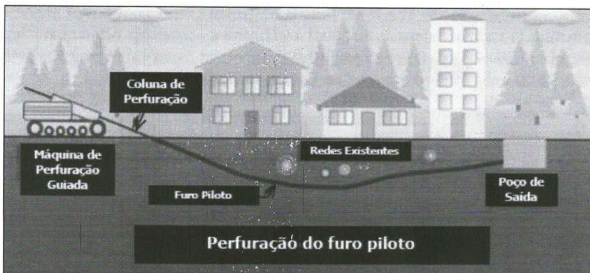
Figura 5 – Ilustração da primeira etapa da execução
