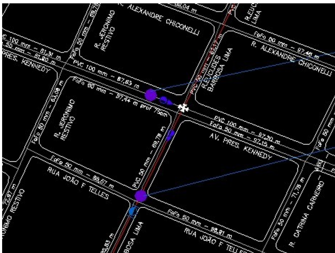
Local de Instalação dos macros medidores.
