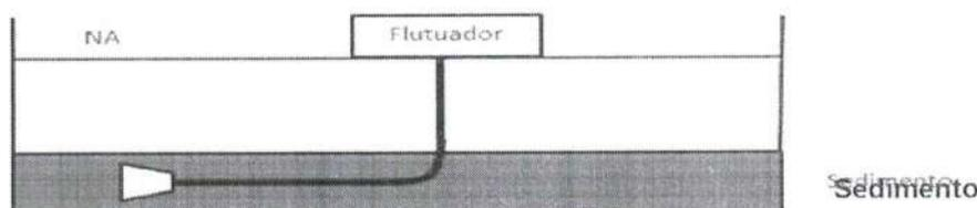
Figura 02 - Lodo sedimentado removido com Coletor Gradual de Resíduos Sólidos, sem turbulência.
